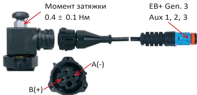
Байонетное соединение DIN 72585 A1-2.1-SN/K1
