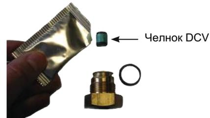
Нанесите на челнок DCV немного смазки.
