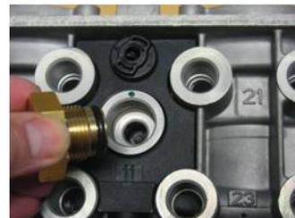
Снимите гайку DCV
