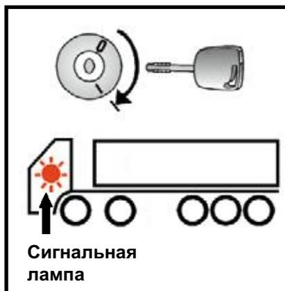
1. При включении системы сигнальная лампа ABS должна указывать в следующей последовательности, чтобы показать отсутствие ошибок в системе:
